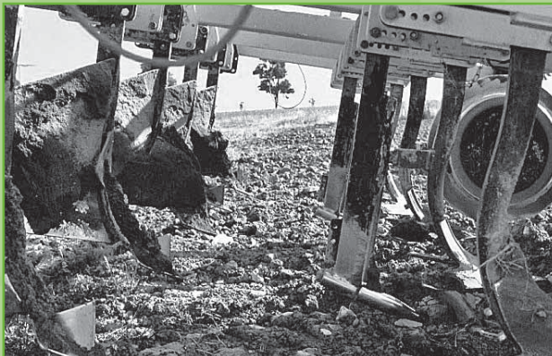
Neli erinevat tööorganit võimaldavad mitmeid kombinatsioone kõrvuti ja üksteise järel. Raami taha paigutatud tööorganid on kaitstud kivikaitseks poldiga.
